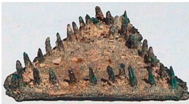
3. CETTE PLAQUE DE CUIVRE CLOUTÉE DE BRONZE (à gauche) est l'un des éléments du revêtement de cuivre du bateau. À la fin du XVIII e siècle, on commence à recouvrir les coques de protection contre les tarets, ces mollusques bivalves à corps allongés en forme de vers, que
