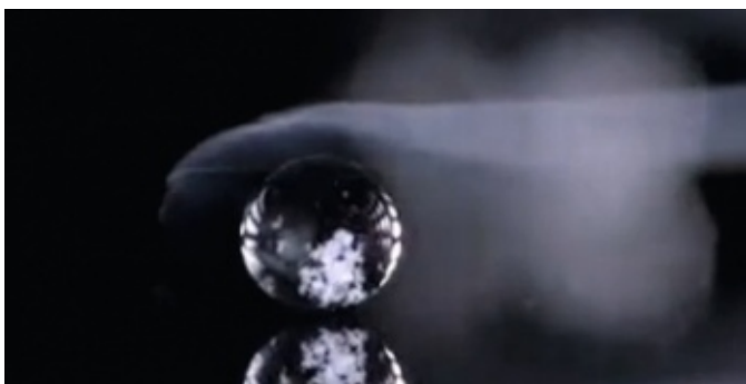
Une goutte d'azote liquide en lévitation sur une surface chaude. Elle est sustentée par la vapeur émise au niveau de sa face inférieure.
