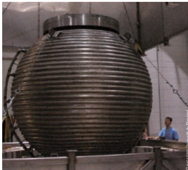
L'expérience de l'Université du Maryland est constituée de deux sphères imbriquées – la plus grande ayant un diamètre de trois mètres. La géométrie s'approche des conditions régnant au sein d'une planète. Elle devrait permettre de reproduire un champ magnétique du type de celui de la Terre à partir de l'effet dynamo.
