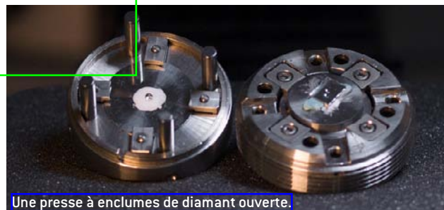
Une presse à enclumes de diamant ouverte.
