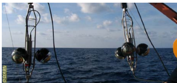
Les photomultiplicateurs d' Antarès en cours d'installation.
