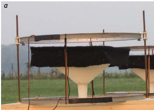
6. LES ENTONNOIRS D'EMLÉN servent à déterminer la direction d'envol des oiseaux migrateurs, retenus captifs par un filet. Les empreintes des oiseaux, qui s'impriment sur le papier recouvrant la paroi de l'entonnoir (b) , montrent que cette direction diffère entre la migration de printemps (c) et celle d'automne (d) . Divers dispositifs permettent d'étudier les indices utilisés par les oiseaux pour s'orienter (a, un bobinage électrique qui crée un champ magnétique artificiel) .
