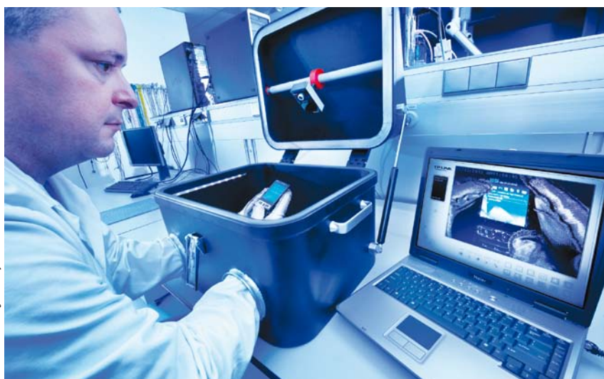
2. LES TÉLÉPHONES PORTABLES sont placés dans une cage de Faraday, qui les isole des signaux radio. On minimise ainsi les risques de changement à distance de la mémoire. Celle-ci peut par exemple s'effacer automatiquement après réception d'un texto particulier. En temps normal, la boîte est fermée et l'analyste manipule le téléphone grâce à la caméra interne.
