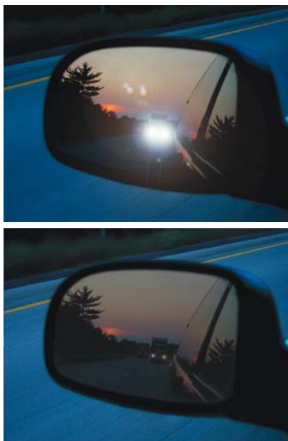
4. DE NOMBREUSES AUTOMOBILES sont équipées des rétroviseurs anti-éblouissement NVS (Night Vision Safety) de Gentex. Quand ils sont activés (en bas), les colorants électrochromes produisent une couleur bleu-vert. L'éblouissement est réduit via l'élimination d'une partie de l'intensité lumineuse et l'absorption de certaines longueurs d'onde.
