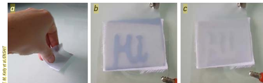
5. LES TISSUS peuvent servir de support pour des matériaux électrochromes. Une équipe de l'École nationale supérieure des arts et industries textiles, à Roubaix, développe des supports souples composés de textiles (a). Un textile sert de réservoir pour le composé électrochrome qui prend une teinte bleue lorsqu'il est réduit (b) et qui devient transparent lorsqu'il est oxydé (c). Ce matériau est placé entre deux électrodes textiles conductrices. La transition entre les deux états est rapide (inférieure à deux secondes) et la durée de vie dépasse aujourd'hui trois semaines (un progrès d'un facteur 10 par rapport à des dispositifs précédents).
