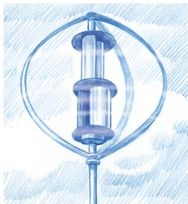
3. UNE ÉOLIENNE MIXTE DARRIEUS-SAVONIUS. Aux pales de type Darrieus s'ajoutent deux dispositifs formés chacun de deux godets cylindriques décentrés et se faisant face. Le vent, en s'engouffrant entre les deux godets, crée un couple de forces (en orange) qui fait tourner le dispositif autour de son axe. Les deux dispositifs sont orientés à 90 degrés l'un de l'autre pour que le vent agisse quelle que soit sa direction.
