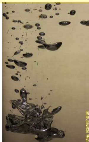
Une chute de gallium dans un liquide, simulant celle du fer dans l'océan magmatique primordial.
