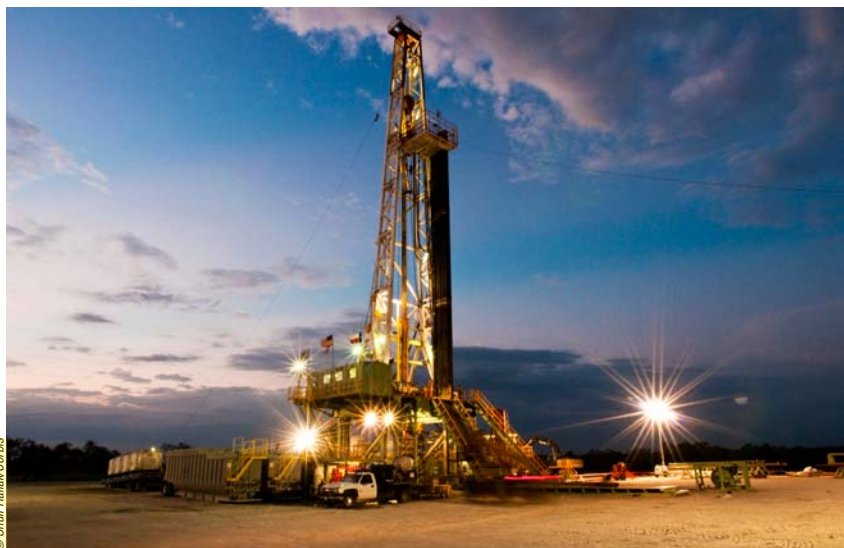
UN FORAGE POUR L'EXTRACTION DE GAZ DE SCHISTE , dans la formation sédimentaire d'Eagle Ford, au Texas. Plus difficiles à récupérer que les hydrocarbures conventionnels, les gaz et huiles de schiste nécessitent un grand nombre d'infrastructures (forages, bassins pour stocker l'eau, routes, etc.). Cette « pollution de surface » est l'un des problèmes majeurs de leur exploitation.
