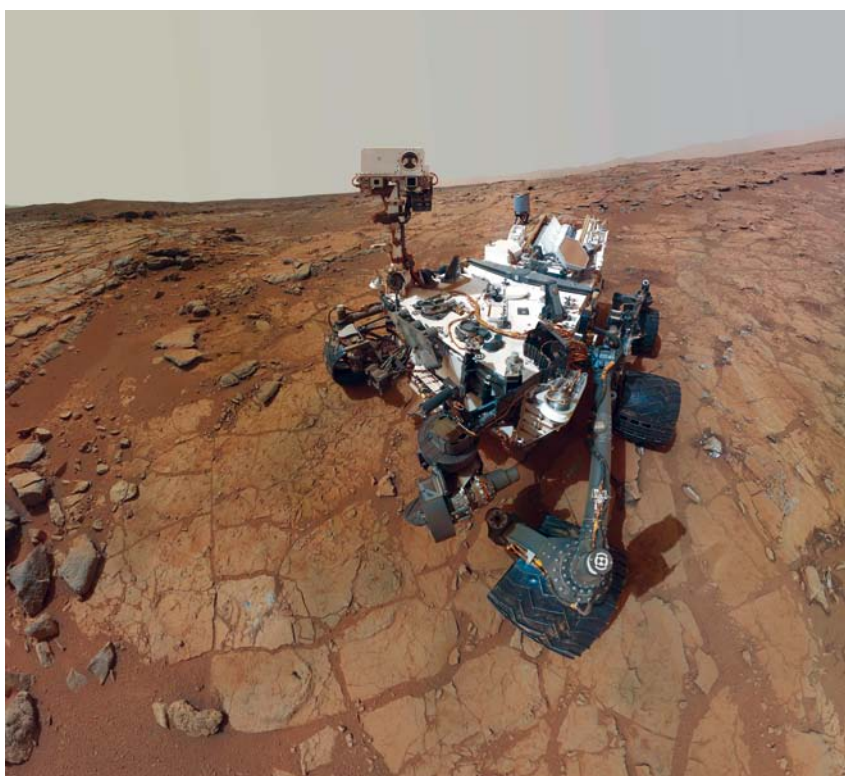
LE ROVER CURIOSITY a été conçu pour étudier la géologie et le climat martien. Il a effectué des forages, ce que fera aussi son successeur, mais pour chercher des traces de vie.
