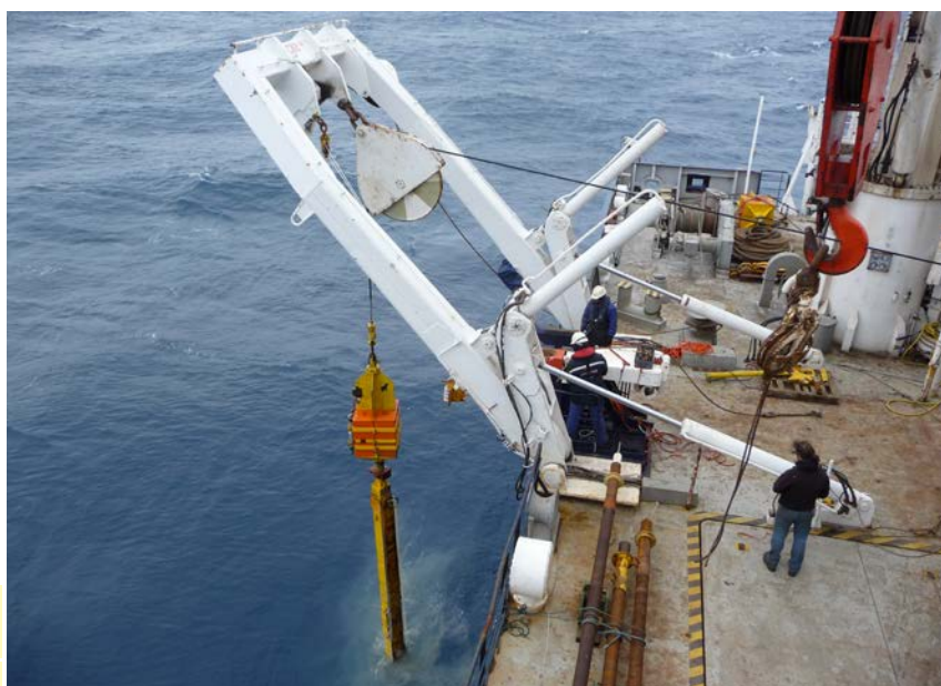
LA REMONTÉE D'UN CAROTTIER à bord du Marion-Dufresne , lors d'une campagne océanographique menée dans l'océan Indien en 2011.
