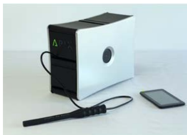
UN SYSTÈME D'ANALYSE DE GAZ de la société Apix, incorporant les capteurs NEMS du CEA-Leti.
