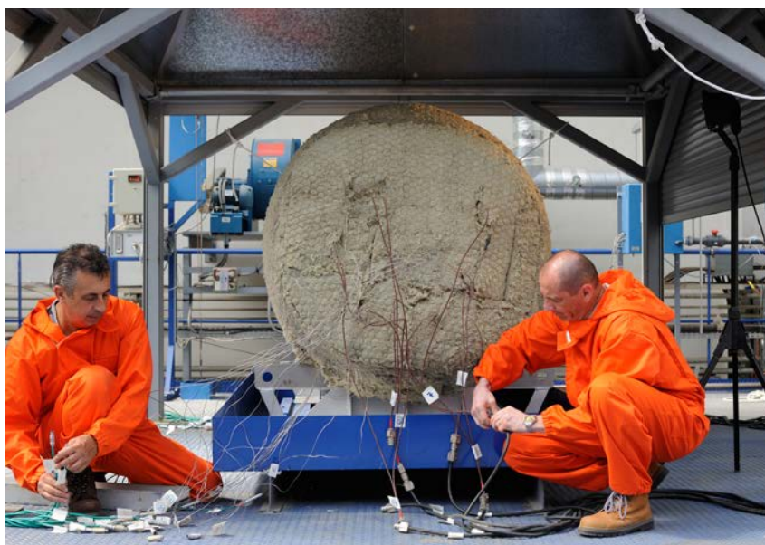
MOYENS D'ESSAIS de systèmes de détection de fuite sur les tuyauteries du circuit de sodium secondaire d' Astrid .
