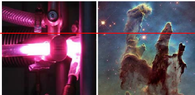
En laboratoire, de la glace, mélange d'eau, d'ammoniac et de méthanol, est exposée à un rayonnement ultraviolet (à gauche) pour reproduire les conditions d'un nuage moléculaire (à droite, les Piliers de la création).
