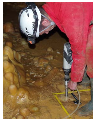
LE CAROTTAGE d'une couche de calcite du sol de la structure est une opération qui demande plusieurs minutes de forage.
