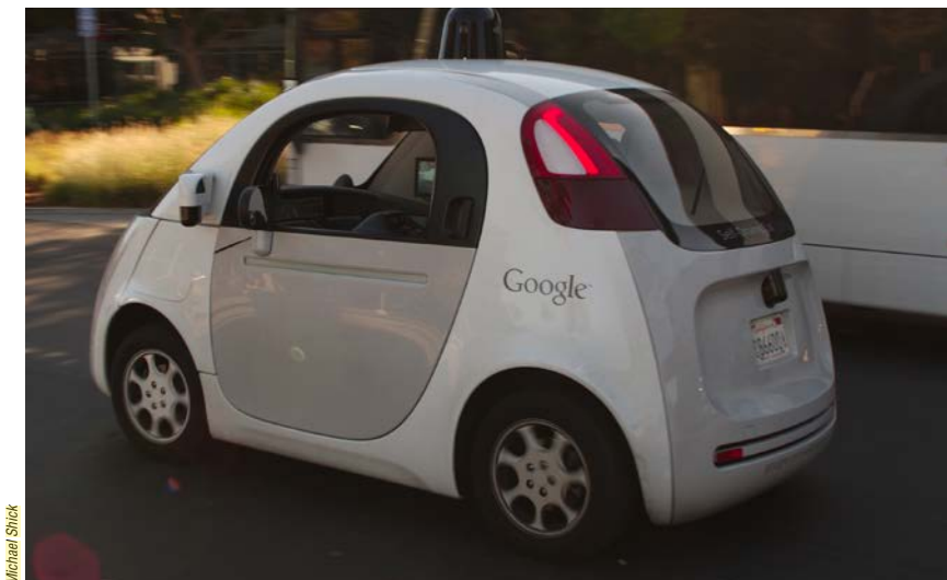
LA GOOGLE CAR est un prototype de voiture partiellement automatisée, à propulsion électrique, sans volant ni commandes pour un conducteur humain. L'ordinateur qui la pilote exploite les données d'un lidar, d'une caméra, de radars, d'un récepteur GPS et de capteurs sur les roues.
