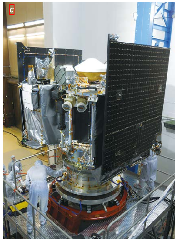
L'ÉPOPÉE D'OSIRIS-REx a débuté douze ans avant son lancement en septembre 2016. La sonde a tout d'abord été assemblée (a), puis testée dans une chambre à vide (b) et dans des laboratoires d'acoustique (c) au sein du complexe Space Systems de Littleton, dans le Colorado, aux États-Unis.
