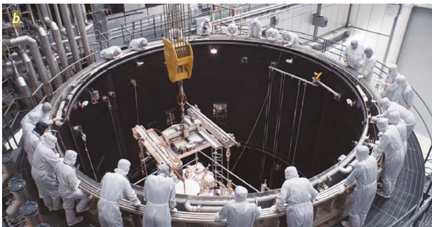
L'ÉPOPÉE D'OSIRIS-REx a débuté douze ans avant son lancement en septembre 2016. La sonde a tout d'abord été assemblée (a), puis testée dans une chambre à vide (b) et dans des laboratoires d'acoustique (c) au sein du complexe Space Systems de Littleton, dans le Colorado, aux États-Unis.
