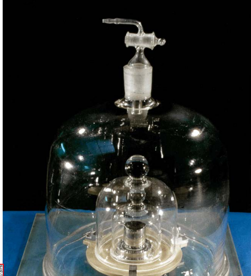
LE GRAND K , cylindre en platine iridié dont on voit ici un fac-similé protégé sous une triple cloche de verre, a été la référence internationale du kilogramme pendant près de 130 ans. La nouvelle définition du kilogramme, prévue pour 2018, s'appuiera sur une constante universelle, la constante de Planck, et non sur un étalon matériel.
