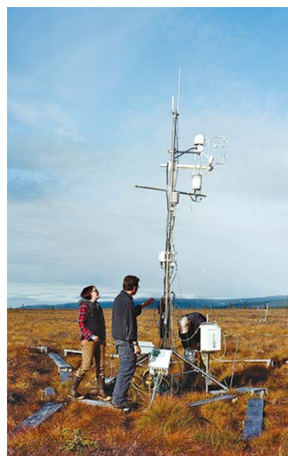
CETTE TOUR INSTRUMENTALE sert à mesurer, tout au long de l'année, les transferts de dioxyde de carbone et de méthane entre le sol et l'atmosphère. Elle permet de faire le bilan des émissions de gaz à effet de serre par l'écosystème de toundra où elle est implantée.
