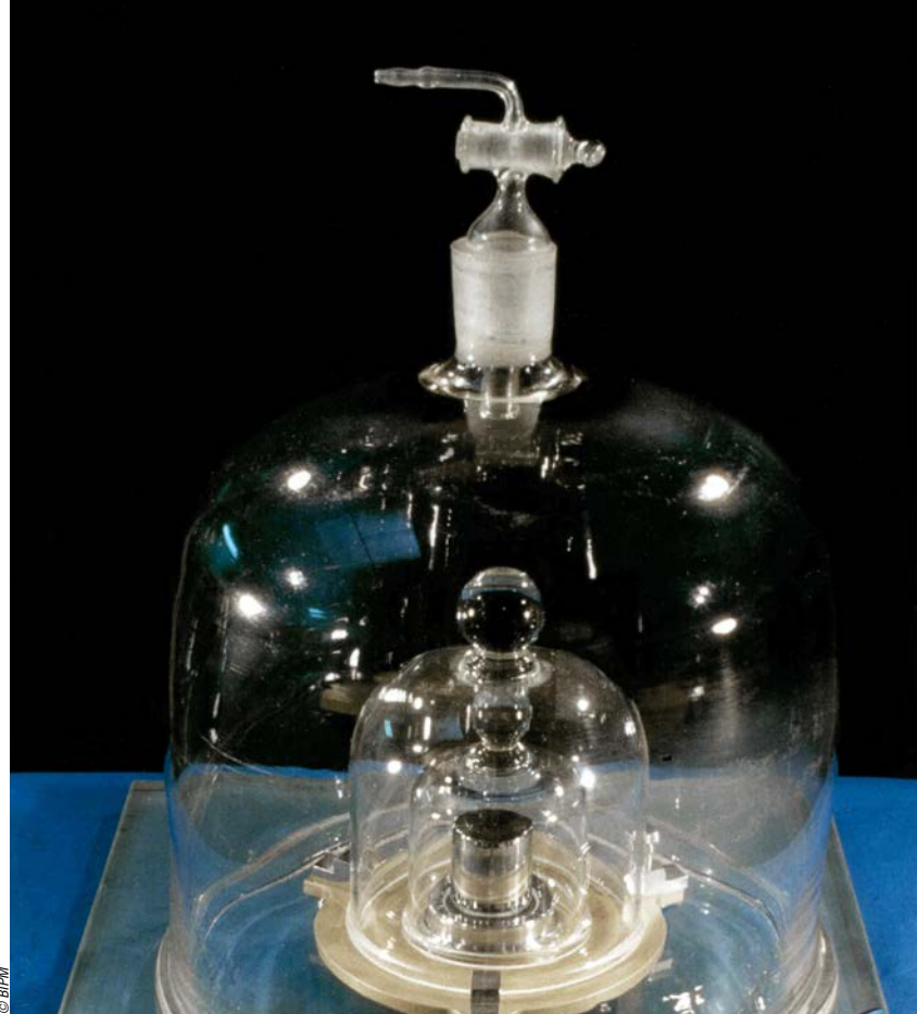
LE GRAND K , cylindre en platine iridiée dont on voit ici un fac-similé protégé sous une triple cloche de verre, a été la référence internationale du kilogramme pendant près de 130 ans. La nouvelle définition du kilogramme, prévue pour 2018, s'appuiera sur une constante universelle, la constante de Planck, et non sur un étalon matériel.
