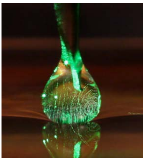
Des particules éclairées par un laser vert mettent en évidence des mouvements de convection dans la goutte.
