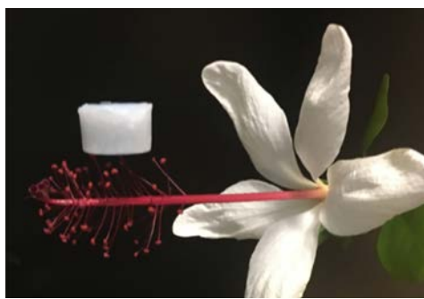
Cet aérogel céramique, posé sur les pistils de la fleur, est très peu dense et néanmoins très robuste.
