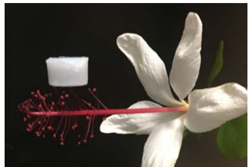
Cet aérogel céramique, posé sur les pistils de la fleur, est très peu dense et néanmoins très robuste.
