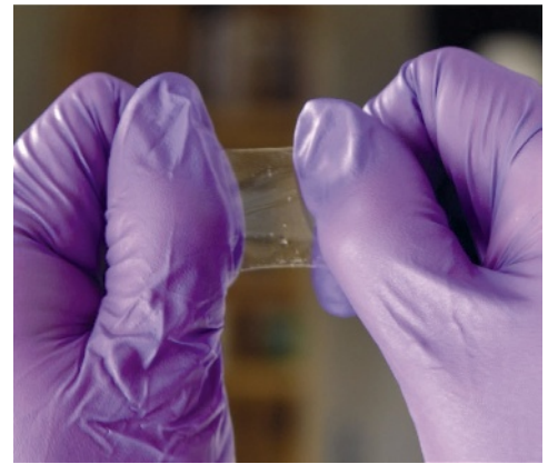
Les chercheurs ont créé des jonctions p-n avec des élastomères en vue de transistors flexibles et transparents.
