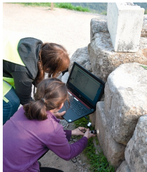
Autre méthode d'examen in situ : le microscope de terrain, qui permet (ici à Marilou de Vals, de Sorbonne Université, et à l'autrice) d'observer et d'enregistrer sur l'ordinateur connecté une image à fort grossissement de la roche.
