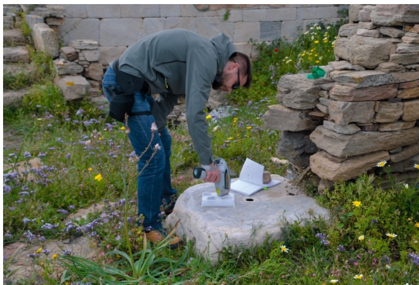
L'une des techniques d'analyse in situ utilisées est la fluorescence X. La photo montre ainsi Sylvain Pont, du MNHN, dressant avec une « fluX » portable la carte chimique d'un chapiteau, en s'assurant grâce à des échantillons étalonnés que l'appareil reste bien calibré.
