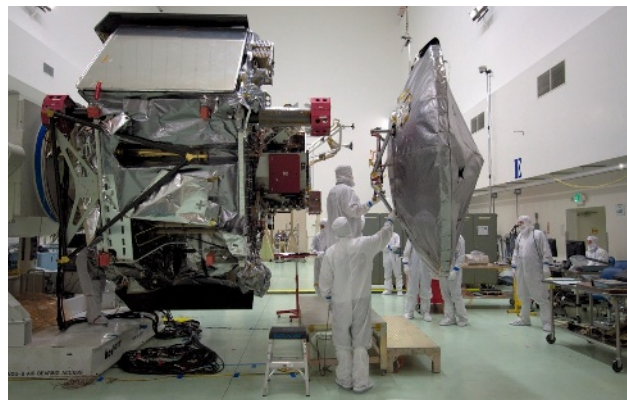
Assemblage en salle blanche de l'antenne à grand gain sur la sonde Juno .
