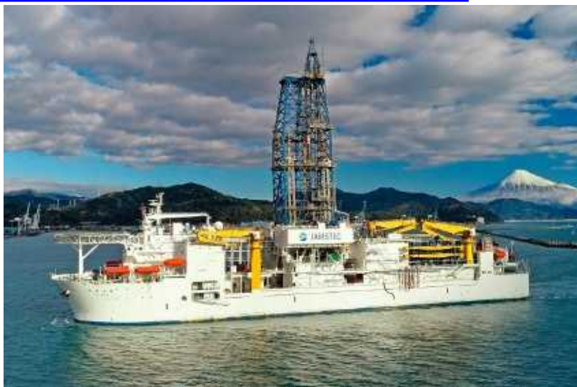
L'équipe internationale a fait appel au navire Chikyu , équipé pour forer à plus de 1 kilomètre de profondeur dans le plancher océanique, lui-même situé, dans la dépression océanique de Nankai, à près de 4,8 kilomètres sous la surface.
