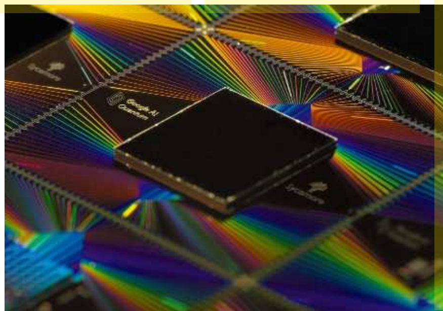
Le processeur Sycamore qui est au cœur de l'ordinateur quantique de Google manipule 53 qubits. Il est programmable, contrairement au dispositif photonique de l'équipe de Hefei.
