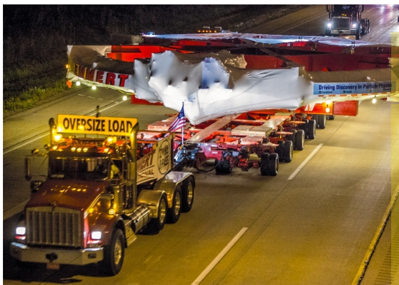
Transporté de New York à Chicago par bateau et par camion, l'anneau de stockage des muons de l'expérience E821, qui mesure 14,2 mètres de diamètre et pèse 700 tonnes, a été réutilisé pour l'expérience Muon g-2 .
