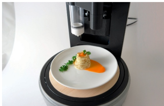
Création d'un plat à base de purée de carotte par une imprimante 3D.
