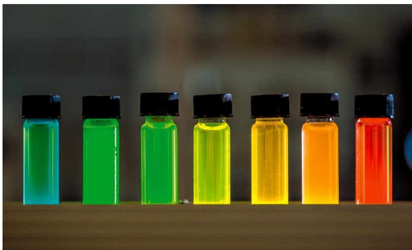
Dans des nanosphères semi-conductrices, ou boîtes quantiques, l'énergie des électrons est quantifiée et dépend du diamètre des structures. En contrôlant ce dernier paramètre, il est possible d'ajuster finement les longueurs d'onde absorbées et émises par fluorescence. Chacun des tubes contient une solution avec des nanosphères d'un diamètre spécifique, ce qui lui donne une couleur différente.
